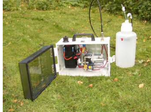
Figura 1 - Particolare di un lisimetro a disco (PRENART soil disc) e, a destra, pompa a vuoto portatile collegata ad una bottiglia per la raccolta delle soluzioni dal lisimetro
