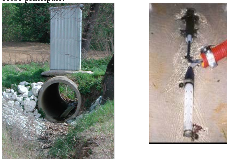
Figura 5 - Dispositivo di monitoraggio del deflusso superficiale installato nel fosso collettore del bacino Bottiglie. A destra: dettaglio della sonda di misura della portata “ area velocity ” (sullo sfondo) e del terminale del campionatore.
